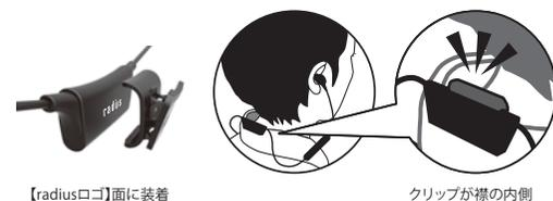
①クリップをバッテリーケース【radiusロゴ】面に装着し、襟元にバッテリーケースを装着することができます。
