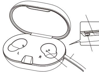
(電源ON/OFF)操作タッチパネル イヤーピース LEDランプ マイク(筐体内)
